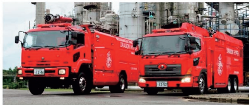
ドラゴンハイパー・コマンドユニットの中核車両である大型放水砲搭載ホース延長車(左)と大容量送水ポンプ車(右)
